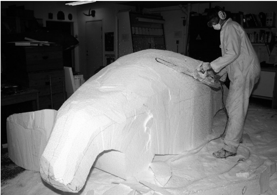
Grovformerna av det nästan fem meter långa cellplastblocket skulpteras med motorsåg. Därefter förfinas detaljerna med kebabkniv, rasp och sandpapper. Foto: Åsa Holmberg.
